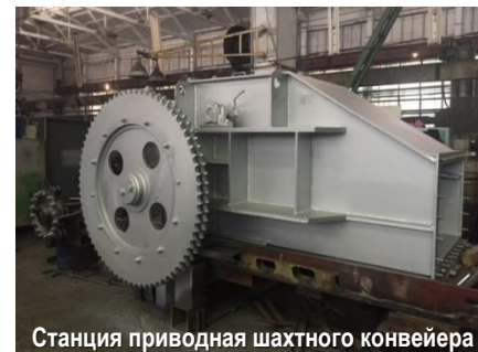
Станция приводная шахтного конвейера
